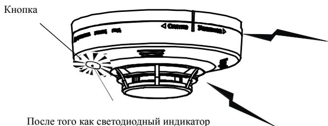
После того как светодиодный индикатор (красный) мигнет 3 раза подряд, он будет трижды мигать каждые 16 с вплоть до устранения неисправности или нажатия кнопки.
