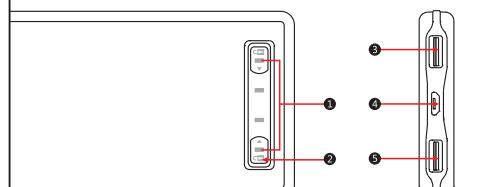
① Индикатор мощности ② Кнопка включения ③ Входной USB порт 1
