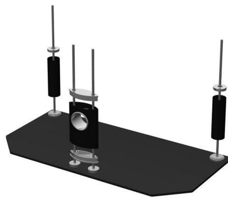
**Шаг 2.** На шпильки установите трубы и профиль с узлами разрыва
