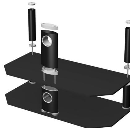
**Шаг 3.** Наложите полку, на шпильки установите трубы и профиль с узлами разрыва
