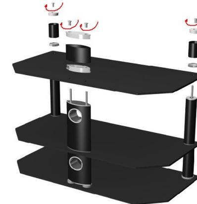
**Шаг 4.** Наложите полку, на шпильки установите трубы и профиль с узлами разрыва и опор, закрепите с помощью гаек
