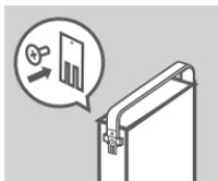
1. Прикрепите кронштейны для жестких дисков сзади жестких дисков с помощью винтов, входящих в комплект поставки. Убедитесь, что кронштейны выровнены таким образом, что при установке жесткого диска стрелка на кронштейне указывает на переднюю панель ShareCenter.
