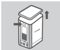
2. Снимите верхнюю крышку с ShareCenter, нажав кнопку PUSH на задней панели и подняв крышку.
