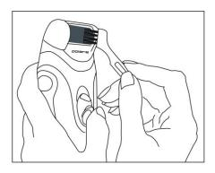
Для тщательной очистки рекомендуется снять шлифовальный ролик и вычистить щёточкой сам ролик и место его установки.
