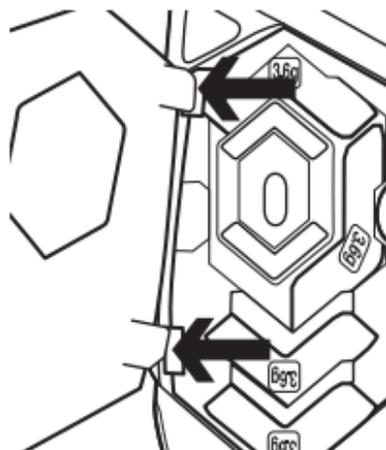
После размещения гирек закройте крышку отсека регулировки веса, установив язычки на крышке в гнезда на левой стороне мыши. Поворачивайте крышку вниз, пока она не будет плотно закрыта с помощью магнита.
