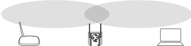
Идеальное расположение для усилителя сигнала - посередине между вашим беспроводным маршрутизатором и устройством с поддержкой Wi-Fi.
