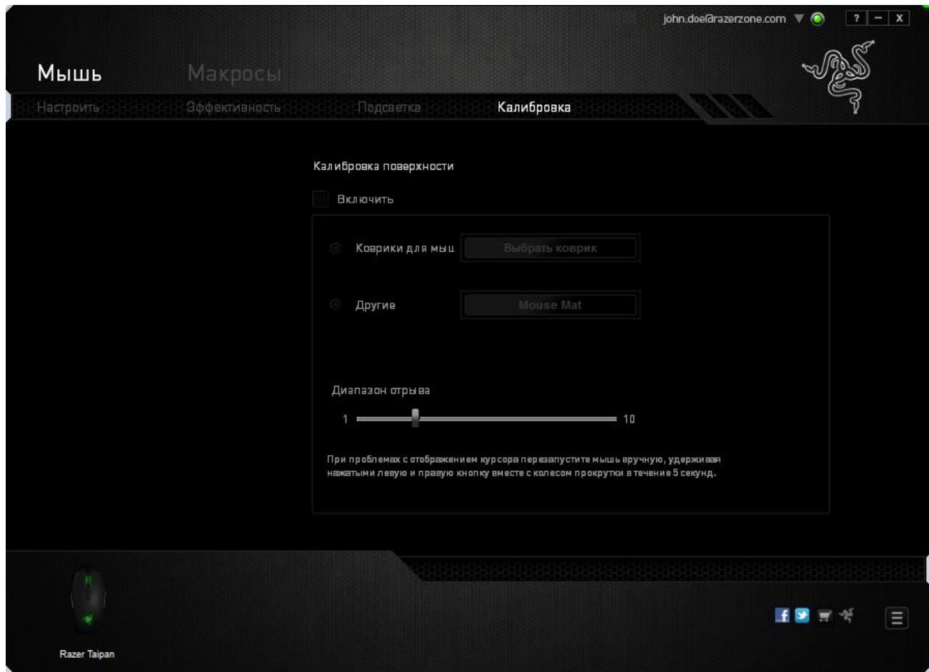
Параметр ДИАПАЗОН ОТРЫВА позволяет задать значение расстояния, при котором датчик перестает функционировать при отрыве мыши от рабочей поверхности. Чтобы использовать данную возможность, сначала необходимо активировать параметр КАЛИБРОВКА ПОВЕРХНОСТИ, а затем выбрать соответствующую рабочую поверхность.
