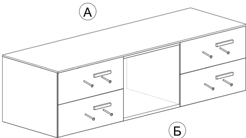
Прикрутить к тумбе ручки винтами с помощью отвертки
