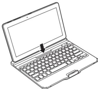
Чтобы снять планшет с устройства, поднимите его вверх.
