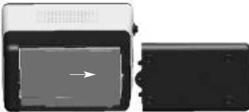
*Шаг 3: После того, как крышка снята, аккуратно вытащите аккумулятор, отсоединив два провода, подсоединенных к IPPON Back Verso. Убедитесь, что вы производите замену на тот же тип аккумулятора.*
