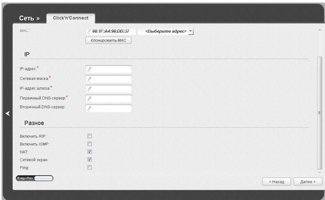
Рисунок 38. Настройка WAN-соединения типа PPTP + Статический IP. Экспертный режим настроек. Разделы IP и Разное.
