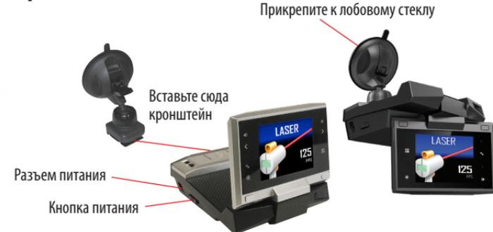
Перед закреплением на лобовом стекле поднимите рычаг на присоске. Закрепив присоску, с усилием прижмите ее к лобовому стеклу, а затем опустите рычаг вниз в положение фиксации. Выровняйте детектор и направьте его вперед с помощью шарового шарнира. Откиньте дисплей вверх или вниз в зависимости от выбранного места крепления детектора и поверните его к себе. Чтобы восстановить работоспособность присоски, протрите ее влажной тканью или промойте в проточной воде.
