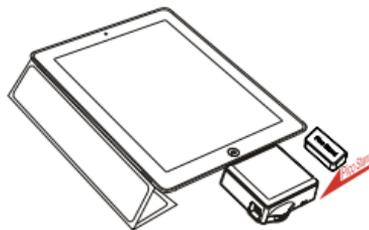
\* Вы можете установить крышку разъема проектора «Pico Stand» под проектор, как показано на рисунке, для сохранения параллельной проекции изображения изображения при подключении iPad. (подставка для iPad не входит в комплект)
