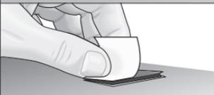
**4.** Прикрепите детектор к крепежной пластине с лентой Велькро. Устройство можно снимать и снова прикреплять без ограничений.
