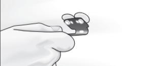
4. Прикрепите детектор к кронштейну. Проверьте угол наклона устройства.
