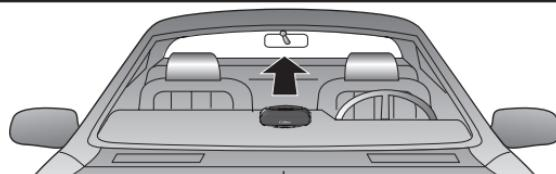
Сигналы радаров и лазерных устройств проходят через стекло, но не проходят через другие материалы и предметы. Воспрепятствовать приему сигнала или ослабить его могут, в частности, следующие предметы:
