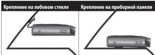
Необходимо обеспечить отсутствие препятствий перед объективом устройства, а также свободный обзор заднего стекла из местоположения линзы LaserEye для обнаружения с охватом 360°.
