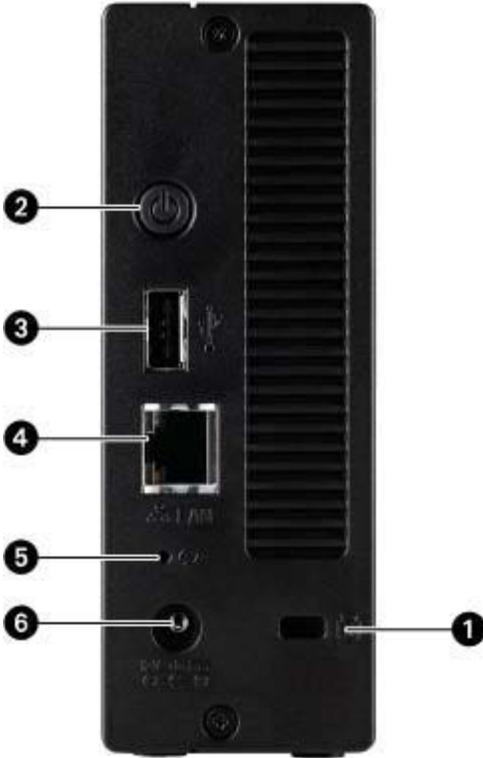
1. **Замок безопасности** — для предотвращения кражи используйте специальный тросик безопасности.
