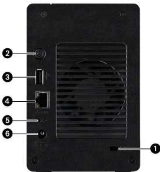
1. **Замок безопасности** — для предотвращения кражи используйте специальный тросик безопасности.
