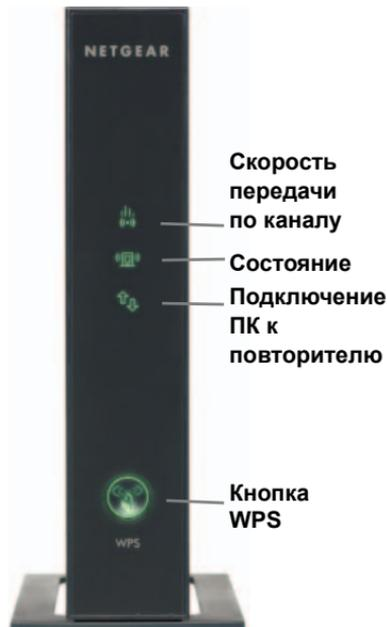
На задней панели расположены следующие функциональные элементы:
