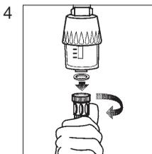
4) Поместите другую прокладку 3/4 на место соединения заливного шланга. Накрутите заливной шланг на мультифильтр, используя, при необходимости, плоскогубцы.
