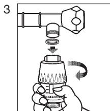
3) Прикрутите на кран мульти-фильтр, затянув его вручную.
