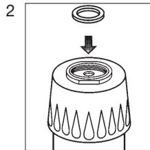
2) Разместите одну из двух прокладок 3/4 внутри углубления на крышке фильтра.
