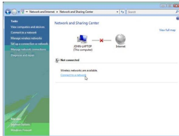
**A-10** В разделе "Network and Sharing Center" ("Центр сетевой связи и общего доступа") нажмите "Connect to a network" ("Подключиться к сети").
