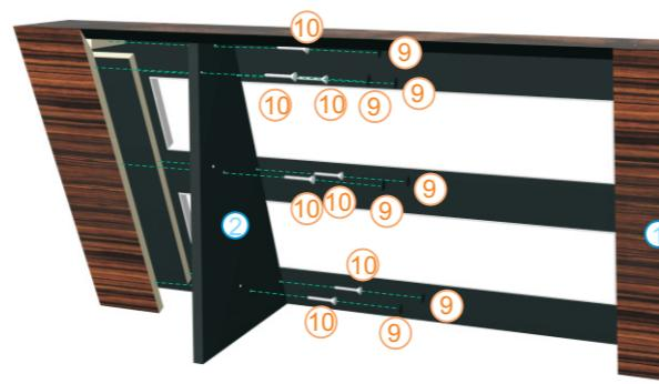
Шаг 1. Прикрепите левую боковую панель (2) на основном корпусе (1) при помощи шурупов (10, 4x40) таким образом, чтобы просверленная часть оставалась на внутренней стороне стойки. После закрепления, пожалуйста, приклейте маленькие наклейки (9) поверх шурупов.
