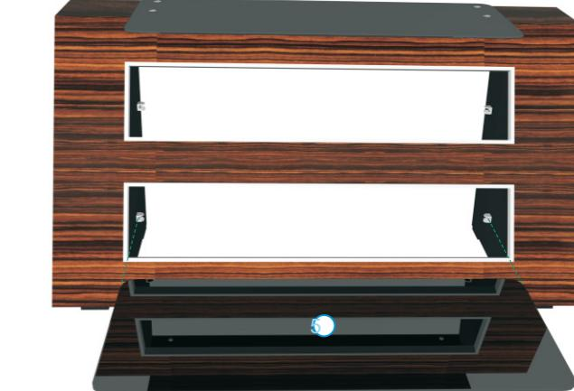
Шаг 6. Пожалуйста, вставьте стеклянные полки (5, 6) в предназначенные для них места и закрепите шурупы таким образом, чтобы стеклянные полки не двигались.
