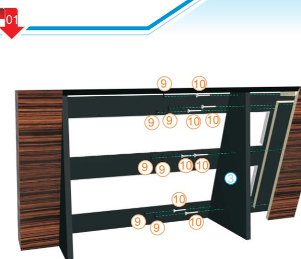
Шаг 2. Прикрепите правую боковую панель (3) на основном корпусе (1) при помощи шурупов (10, 4x40) таким образом, чтобы просверленная часть оставалась на внутренней стороне стойки. После закрепления, пожалуйста, приклейте маленькие наклейки (9) поверх шурупов.
