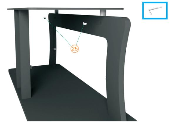
р.с: При ввинчивании шурупчика, отмеченного номером 25, стрелка должна быть направлена вверх
