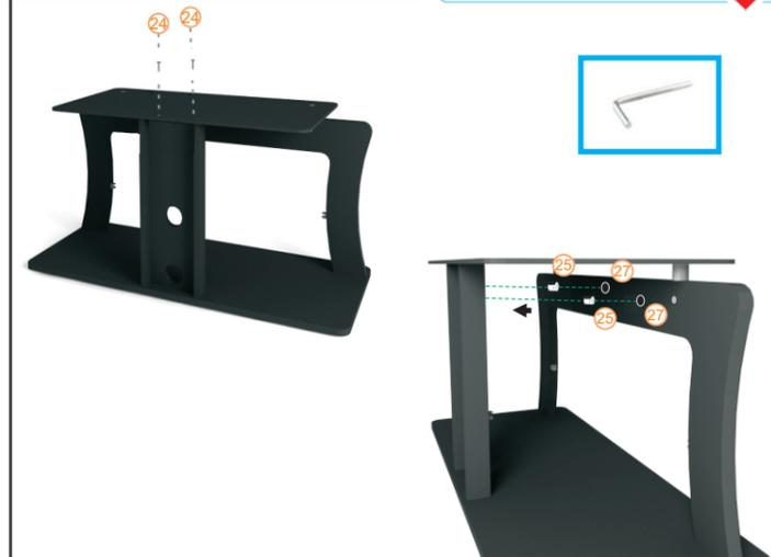
р.с: При ввинчивании шурупчика, отмеченного номером 25, стрелка должна быть направлена вверх
