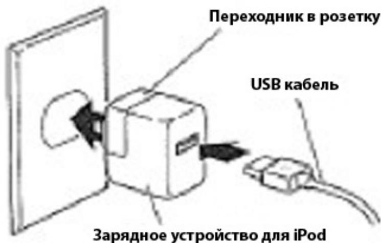
Подключите ваш iPod к адаптеру питания с помощью USB-шнура, входящего в комплект адаптера или плеера iPod. Оригинальный iPod shuffle можно подключить к адаптеру напрямую. Затем выдвиньте штепсельные контакты, если необходимо, и вставьте штепсельную вилку адаптера в розетку электросети, чтобы зарядить батарею плеера iPod.
