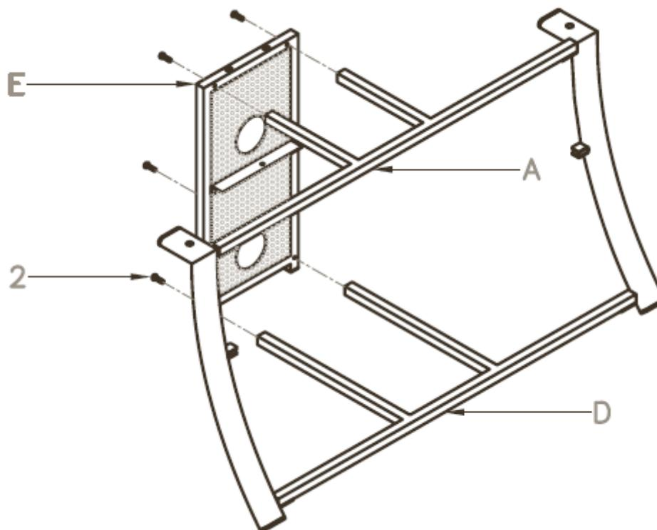
**2. УСТАНОВИТЕ** рамку (E) CMS® (Устройство скрытой прокладки кабеля) отверстиями, расположенными в торце, вверх. При этом опора под полочку должна быть направлена вовнутрь, как это показано на рисунке.
