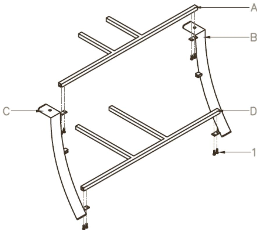
**1. ЗАКРЕПИТЕ** опорную планку верхней полки (**A**) и опорную планку нижней полки (**D**) на боковых стойках (**B** и **C**) при помощи 12 мм болтов (**1**), после чего полностью затяните болты.
