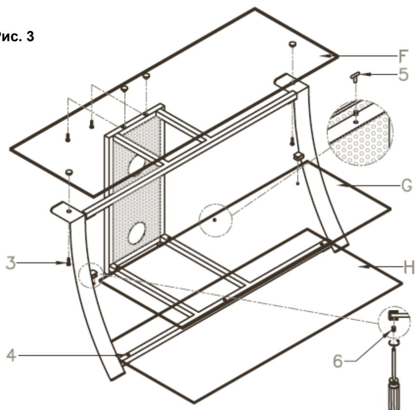
4. **УСТАНОВИТЕ** подкладки под стекло (4) в отверстия в опорной планке нижней полки.
