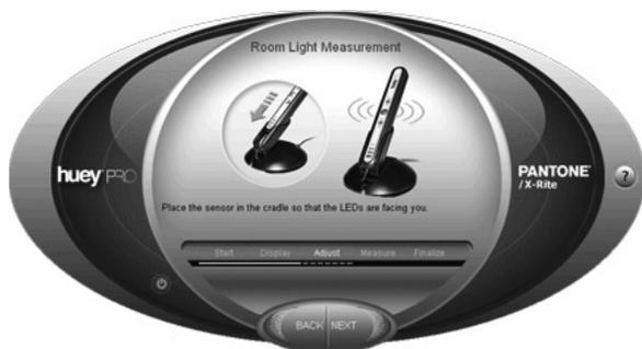
**Примечание:** Сенсор окружающего освещения предназначен для настройки контрастности вашего монитора в соответствии с условиями освещенности вашей комнаты. Это помогает сохранять изображение на мониторе выглядящим одинаково при изменении освещенности в течение дня. Этот сенсор измеряет окружающий свет перед калибровкой.
