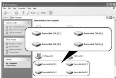
Обозначенные буквами значки съемных дисков, соответствующие слотам для карт памяти CompactFlash/Microdrive, SmartMedia/xD-Picture Card, “Memory Stick” и MultiMediaCard/SD Memory Card, приводятся в алфавитном порядке. Например, если до подсоединения устройства считывания/записи для компьютера отображались диски A:, C: и D:, то после подсоединения устройства считывания/записи дискам будут назначены следующие буквы.
