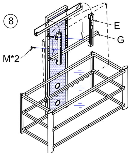
8. После крепления направляющих (E) к телевизору, повесить ТВ на направляющую (F), прикрепить направляющую (G) к направляющей зафиксировать заднюю панель (A) к направляющей (G) болтами (M)
