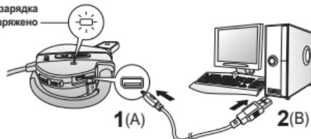
1. Подключите узкий конец (A) USB-кабеля к USB-порту стереогарнитуры.
