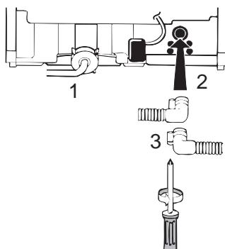
Любая точка сливного шланга должна находиться ниже верхней части посудомоечной машины, в противном случае работа машины будет нарушена. Кроме того, важно проверить, что внутренний диаметр сливного шланга по всей его длине равен не менее 13 мм. Если сливной шланг оказался слишком длинным, его можно легко обрезать до необходимой длины.
