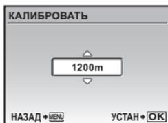
На экран выводится значение атмосферного давления и высоты/глубины при съемке (от -10 м до 5 000 м). Если глубина погружения приближается к 10 м, на экран выводится предупреждающее сообщение.
