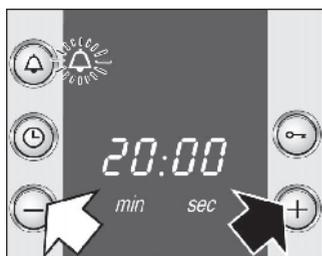
2. Установите время таймера с помощью кнопки + или кнопки -. На дисплее появляется предлагаемое значение времени таймера. При нажатии кнопки + предлагаемое значение = 10 минут. При нажатии кнопки - предлагаемое значение = 5 минут.
