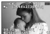
Отображение номера кадра, данных печати, защиты, режима записи, количества пикселей, уровня сжатия, даты/времени и номера файла.
