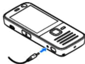
2. Подсоедините провод питания к устройству. Если аккумулятор полностью разряжен, шкала индикатора уровня заряда аккумулятора может начать перемещаться только через некоторое время.
