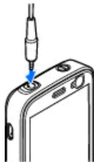
Некоторые мини-гарнитуры состоят из двух частей: модуля дистанционного управления и наушников. Модуль дистанционного управления содержит микрофон и клавиши для приема и завершения вызовов, регулировки громкости и воспроизведения музыкальных или видеофайлов. Для использования наушников с модулем дистанционного управления подключите модуль к разъему Nokia AV (3,5 мм) устройства, затем подключите наушники к модулю.
