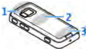
1 — Антенна Bluetooth и беспроводной локальной сети, а также приемник GPS
