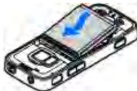
4. Чтобы снова установить панель, сначала направьте верхнюю стопорную защелку в соответствующее гнездо, а затем нажимайте, пока панель не встанет место.
