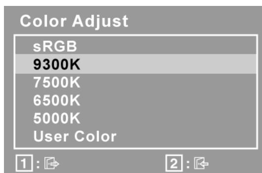
**sRGB**-RGB быстро становится производственным стандартом управления цветом, который поддерживает большинство современных приложений. Эта настройка позволяет более точно отображать цвета на ЖК-дисплее. Включение настройки sRGB делает регулировку контрастности и яркости недоступной.
