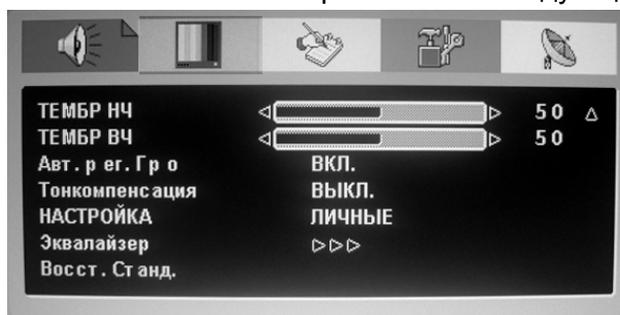
6. «Preset» (Предварительно установленное значение): Предназначено для разных типов выхода звука и обладает четырьмя предварительно установленными режимами: «voice» (речь), «music» (музыка), «personal» (личные настройки) и «theatre» (театр): можно устанавливать параметры «Bass» (Бас), «Treble» (Дискант) и «Equalizer» (Эквалайзер) в режиме выхода звука в соответствии с предпочтениями пользователя.
