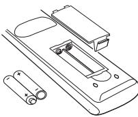
Снимите заднюю крышку, открывающую доступ к батарейному отсеку, и вставьте батарейки, соблюдая полярность. Для данного пульта дистанционного управления подходят батарейки типа AAA, IEC R03 1,5 В.
