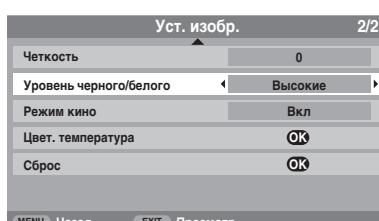
**2** С помощью кнопок  $\blacktriangleleft$  или  $\triangleright$  выберите значение Высокие, Средние, Низкие или Выкл. Эффект зависит от передаваемого сигнала и наиболее заметен на темных цветах.
