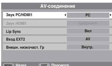
**ПРИМЕЧАНИЕ.** При выборе параметра **PC** звук HDMI будет в цифровом режиме.
