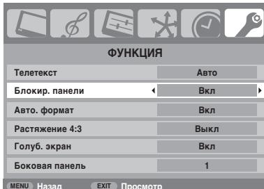
Если для функции **Блокир. панели** установлено значение **Вкл**, при нажатии кнопок на телевизоре отобразится напоминание об этом. **Если будет нажата кнопка режима ожидания, телевизор выключится, и включить его можно будет только с помощью пульта дистанционного управления.**
