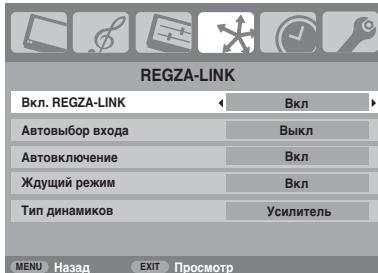
**ПРИМЕЧАНИЕ.** При установке для параметра **Вкл.** REGZA-LINK значения **Выкл** все остальные элементы будут затенены.
