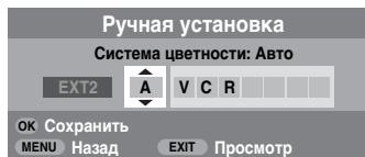
2 С помощью кнопки **▲** или **▼** выберите один из параметров: **Авто**, **PAL**, **SECAM**, **NTSC 4.43** или **3.58**.
