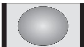
Выберите этот параметр при получении сигнала с 'полосами по бокам', чтобы увеличить изображение на весь экран за счет растягивания по горизонтали и по вертикали с сохранением близких к оригиналу пропорций в центре изображения. Может наблюдаться небольшое искажение.
