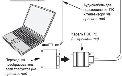
Для использования ПК задайте на нем выходное разрешение для монитора до подключения компьютера к телевизору. Для получения информации о форматах видеосигналов см. стр. 36.
