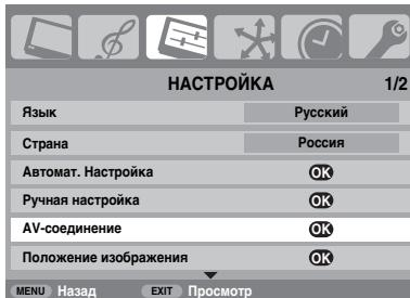
**2** С помощью кнопок или выберите **AV** или **S-VIDEO** в качестве сигнала **входа**, требующегося для гнезда **EXT2**.
