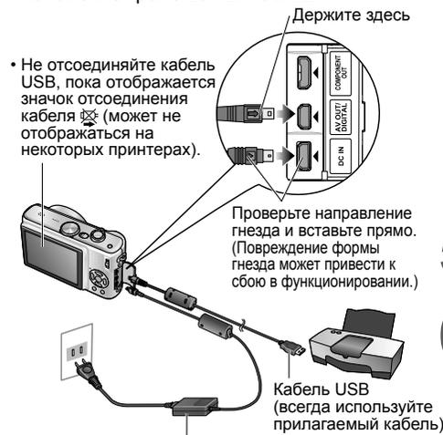
При использовании сетевого адаптера переменного тока выключите питание фотокамеры перед тем, как подсоединять или отсоединять его от сети.
