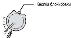
Помимо включения и выключения видеокамеры, переключатель **POWER** также служит для переключения режима работы видеокамеры.
