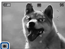
Индикатор блокировки АЭ/АФ
