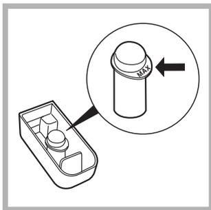
Лоток 4 для отбеливателя вставляется в отделение 1 распределителя моющих средств. Не заполняйте лоток 4 выше отметки max (см. рис.).
