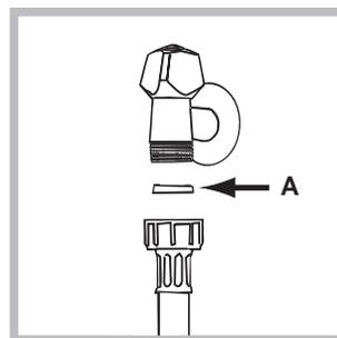
1. Вставьте прокладку **A** в конец заливного шланга и наворачите его на вывод водопровода холодной воды с резьбовым отверстием 3/4 дюйма (см. рис.). Перед подсоединением откройте водопроводный кран и дайте стечь грязной воде.
