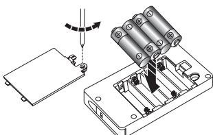
2. Отверткой выкрутите винт фиксации крышки батарейного отсека передатчика, снимите крышку. Соблюдая полярность, как показано на рисунке установите 4 батареи размер AA. Закройте крышку и зафиксируйте ее винтом.
