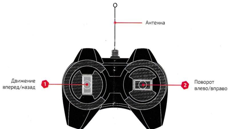
Если машина при движении вперед едет не прямо и при этом правая ручка пульта управления, отвечающая за повороты, находится в нейтральном положении, то нужно скорректировать прямолинейное движение машины. Для чего вручную нужно передвинуть поворотный замок, который находится в нижней части машины, между передними колесами.
