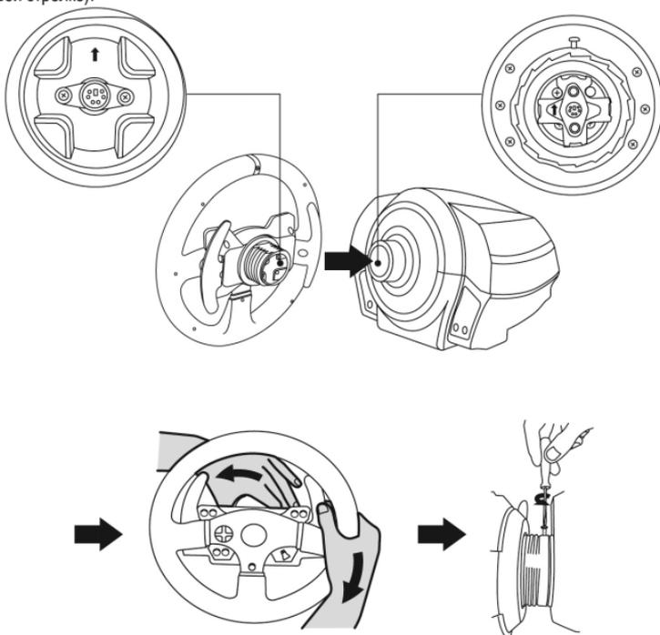
Установив руль, поверните его на 180° (если смотреть на руль, логотип Thrustmaster должен быть перевернут «вверх ногами»), чтобы получить доступ к малому крепежному винту на кольце системы Thrustmaster Quick Release. С помощью большой отвертки Phillips затяните малый крепежный винт (без чрезмерного усилия) по часовой стрелке.
