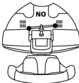
**ПРЕДУПРЕЖДЕНИЕ:** запрещается закручивать винт без использования системы крепления!
