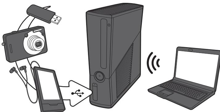
Систему Xbox 360 можно использовать для воспроизведения музыки, просмотра изображений и видеороликов с других устройств. К ней можно подключить различные устройства, портативные аудиопроигрыватели, цифровые камеры и флэш-накопители USB. Кроме того, можно использовать в консоли медиаданные с компьютера с Windows, подключенного к той же домашней сети.
