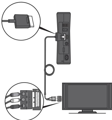
Подключите композитный AV-кабель к телевизору.
