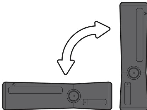
Консоль можно установить горизонтально или вертикально. Прежде чем менять ориентацию консоли, убедитесь в том, что она отключена и в лотке дискового отсутствует диск. Независимо от того, как располагается консоль, проверьте, не закрыты ли вентиляционные отверстия или ИК-приемник.
