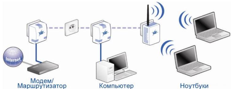
Иллюстрация показывает как два мобильных компьютера могут подключаться к Интернету и к другим компьютерам в домашней сети Qlan® через Wireless extender.
