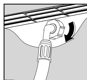
Другой конец наливного шланга, подключающийся к машине, может быть повернут в любом направлении. Ослабьте гайку, поверните шланг и вновь затяните гайку, проверив отсутствие течей воды. Наливной шланг нельзя вытягивать. Если он слишком
