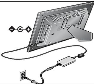
Кабель питания в комплекте конкретного устройства может отличаться от изображенного на рисунке. Пользуйтесь вилкой, соответствующей имеющемуся типу штепсельной розетки.
