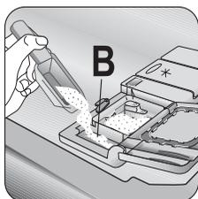
Для программ, включающих цикл предварительной мойки, добавьте дополнительное количество мощного средства в отсек **B**.
