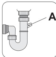
При подсоединении сливного шланга к находящейся под раковиной сливной трубе **следует (А) полностью удалить пластиковую мембрану**. Если не удалить мембрану, частицы пищи, скапливаясь в сливном шланге, со временем могут вызвать его засорение.
