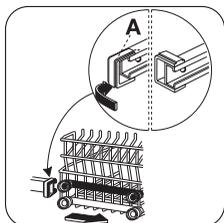
Поднимите стопоры (A) передней направляющей верхней корзины и выдвиньте ее.
