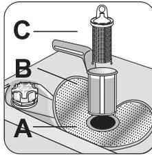
Тщательно промойте фильтры **A**, **B** и **C** под проточной водой.
