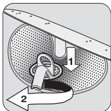
Установите фильтры и зафиксируйте их, повернув ручку по часовой стрелке до упора.
