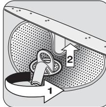
Поверните ручку примерно на 1/4 оборота против часовой стрелки и выньте фильтры **B** и **C**.
