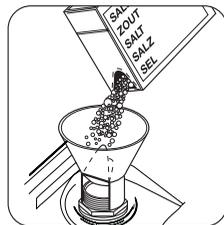
С помощью воронки, поставляемой в комплекте с машиной, доверху засыпьте соль в емкость.
