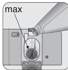
Залейте в дозатор ополаскиватель. Максимальный уровень заполнения соответствует отметке "max"
