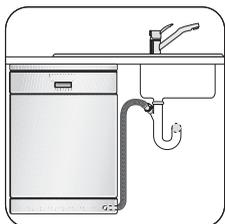
Подсоедините сливной шланг к раковине. Закрепите его с помощью прилагаемого зажима для шланга.
